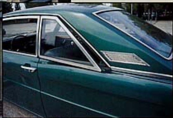
Klimaanlage anno '69 - Zwangs-entlüftung und Ausstellfenster
